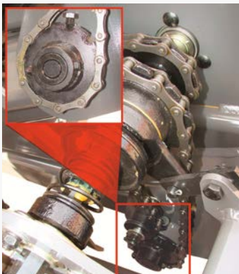
Sistema fusible de protección
