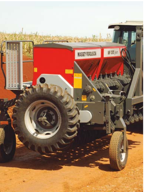
Rodado para transporte longitudinal
