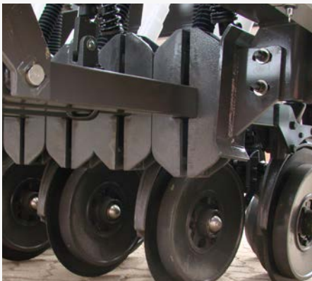
Detalle de las líneas y anillo limitador
