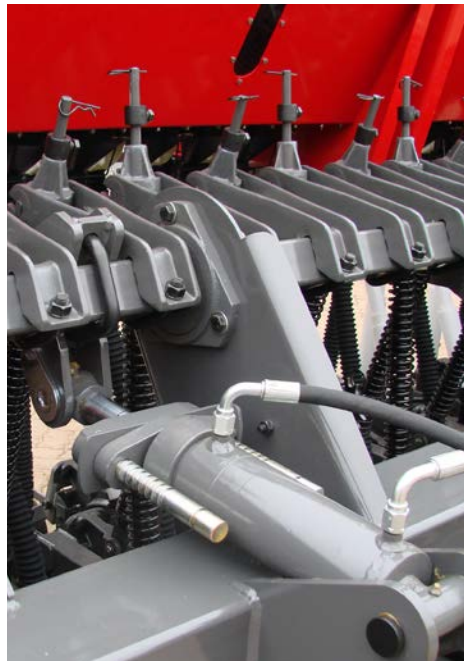
Sistema hidráulico de presión de las líneas
