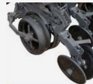
Limitador pivotado lateral y compactador en "V"
