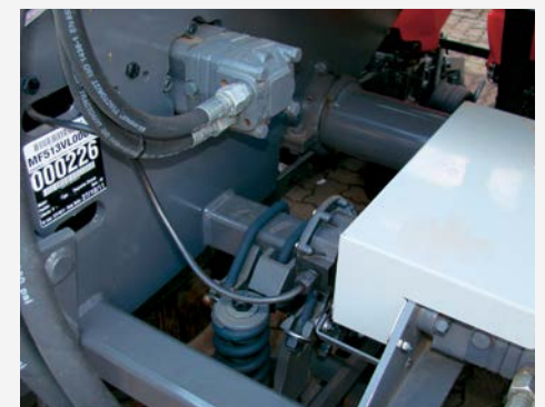
Motor hidráulico responsable del accionamiento del eje del fertilizante
